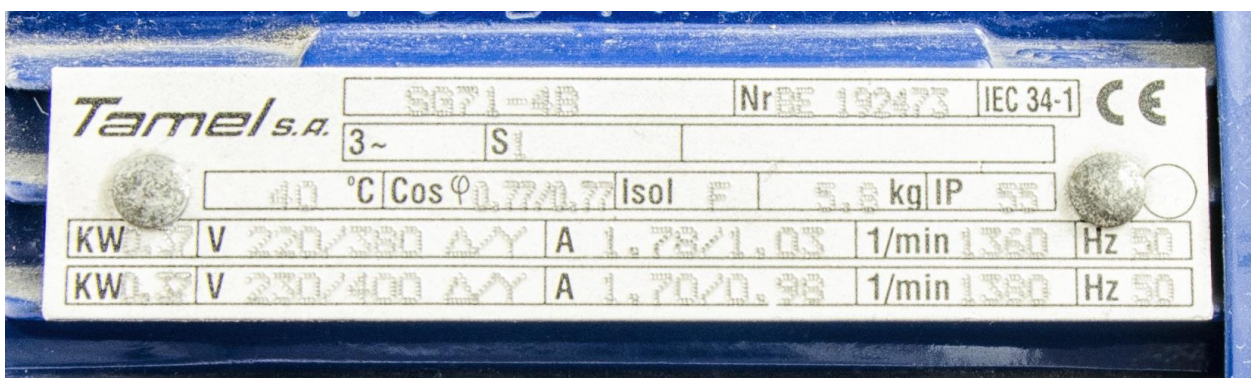
Tabliczka znamionowa silnika 3 fazowego (silnik podłączony w trójkąt).
